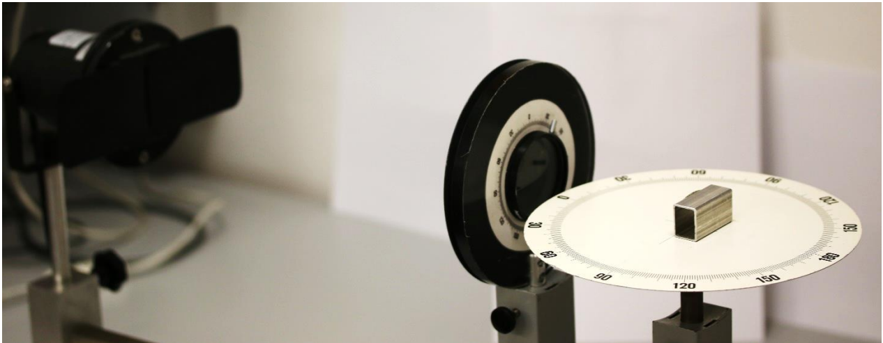
24. ábra: Lámpa réssel; közös lovason a diatartóba csúsztathatóan elhelyezett rés és a polarizátor; a forgatható korongra helyezett ismeretlen törésmutatójú anyag.
