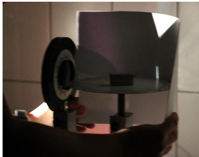
17. ábra: Papírlap ívesen meghajlítva a korong pereme mentén a visszavert fénysugár intenzitásának megfigyelésére.
