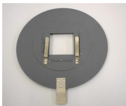
14. ábra: A diatartó két oldala, a jobb oldalon látható a csúsztatósín.
