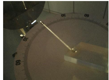
17. ábra: A fénysugár beállítása a résekkel.
