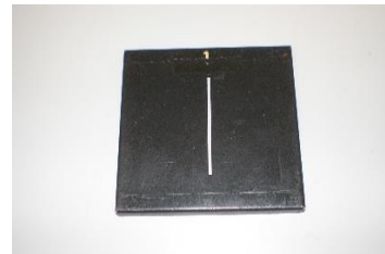
9. ábra: Rés, amit a diatartó csúsztatósínes oldalába kell helyezni.
