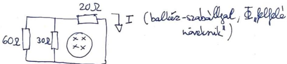
A melenaidban a fluxusváltozás:  $\frac{\Delta \Phi}{\Delta t} = \frac{\Delta}{\Delta t} (B \cdot r^2 \pi) = \frac{\Delta B}{\Delta t} \cdot r^2 \pi = 1,6 \text{ V}$
